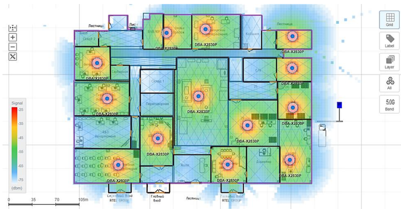
3.3-сурет – Fablab ғимаратында 5G DAS жүйесін қолмен орналастыру нәтижесі
