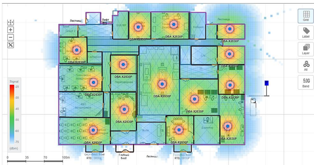
3.4-сурет – Fablab ғимаратында 5G DAS жүйесін қолмен оңтайландыру нәтижесі
